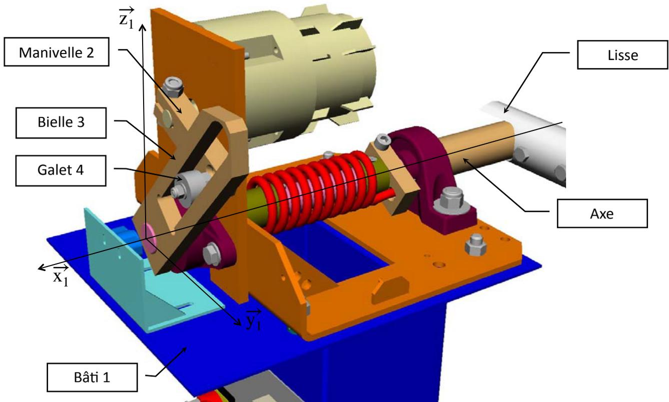
Le schéma ci-dessous donne le paramétrage de ce mécanisme.
